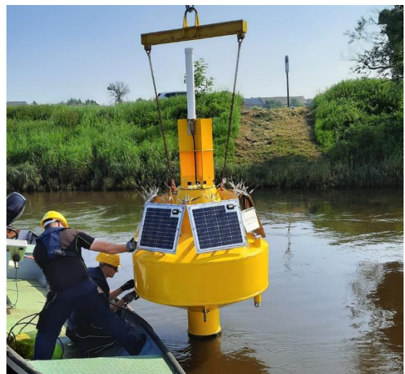
Abbildungen 1 u. 2: Boot mit „Echolot-Harke“ zur mobilen Datenerfassung (links) und Wasserung einer der beiden Echolot-Bojen in einem Bühnenkopfkolk (rechts).
