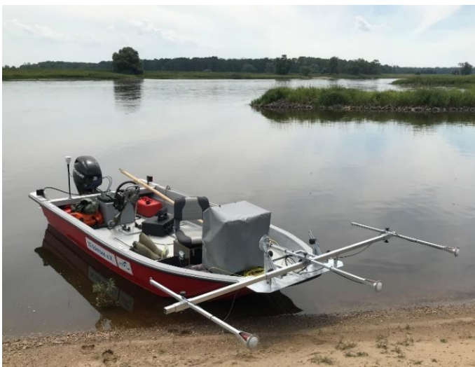
Abbildungen 1 u. 2: Boot mit „Echolot-Harke“ zur mobilen Datenerfassung (links) und Wasserung einer der beiden Echolot-Bojen in einem Bühnenkopfkolk (rechts).
